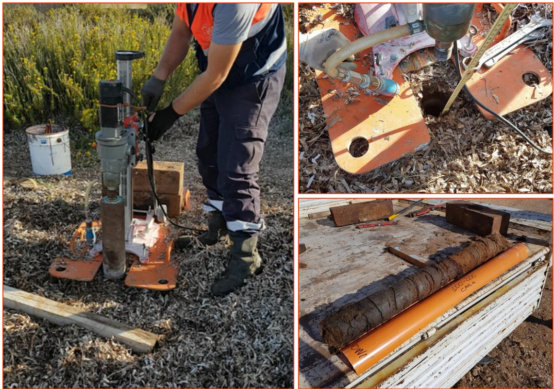
Figura 8 - Fasi del carotaggio di banquette di Capo Feto.
