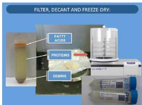
Figura 16. Rappresentazione del processo di pretrattamento. L'omogenato ottenuto dai resti ittici, dopo bollitura e filtraggio, viene lasciato sedimentare così da avere la suddivisione nelle tre fasi idrofoba, idrofila e solida. La fase idrofila è sottoposta al processo di liofilizzazione.
